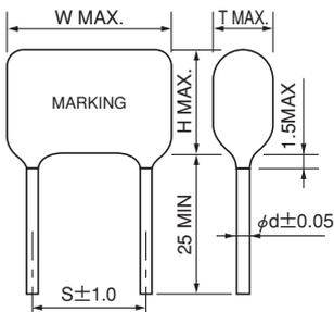
アクロス ザ ラインコンデンサとして使用する場合はコンデンサに並列にバリスタ電圧が定格電圧の2倍以下のバリスタが入っていること、又はコンデンサの両端に定格電圧の2倍以上のパルスが印加されないうちご配慮願います。
